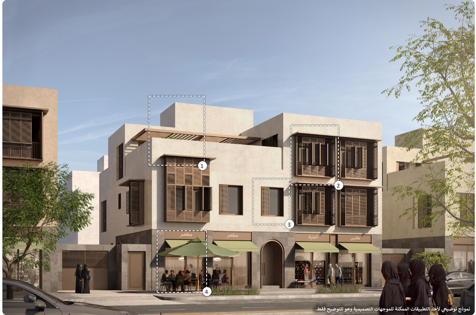
1 سترة سطح (دروة) مسطحة ومستمرة. فراغ في السطح مظلل بسواتر خشبية
