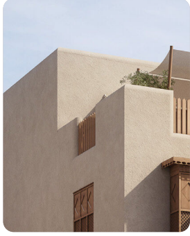
1 أسطح متدرجة مع درابزين مصنوع من الخشب وعناصر تظليل قماشية.
