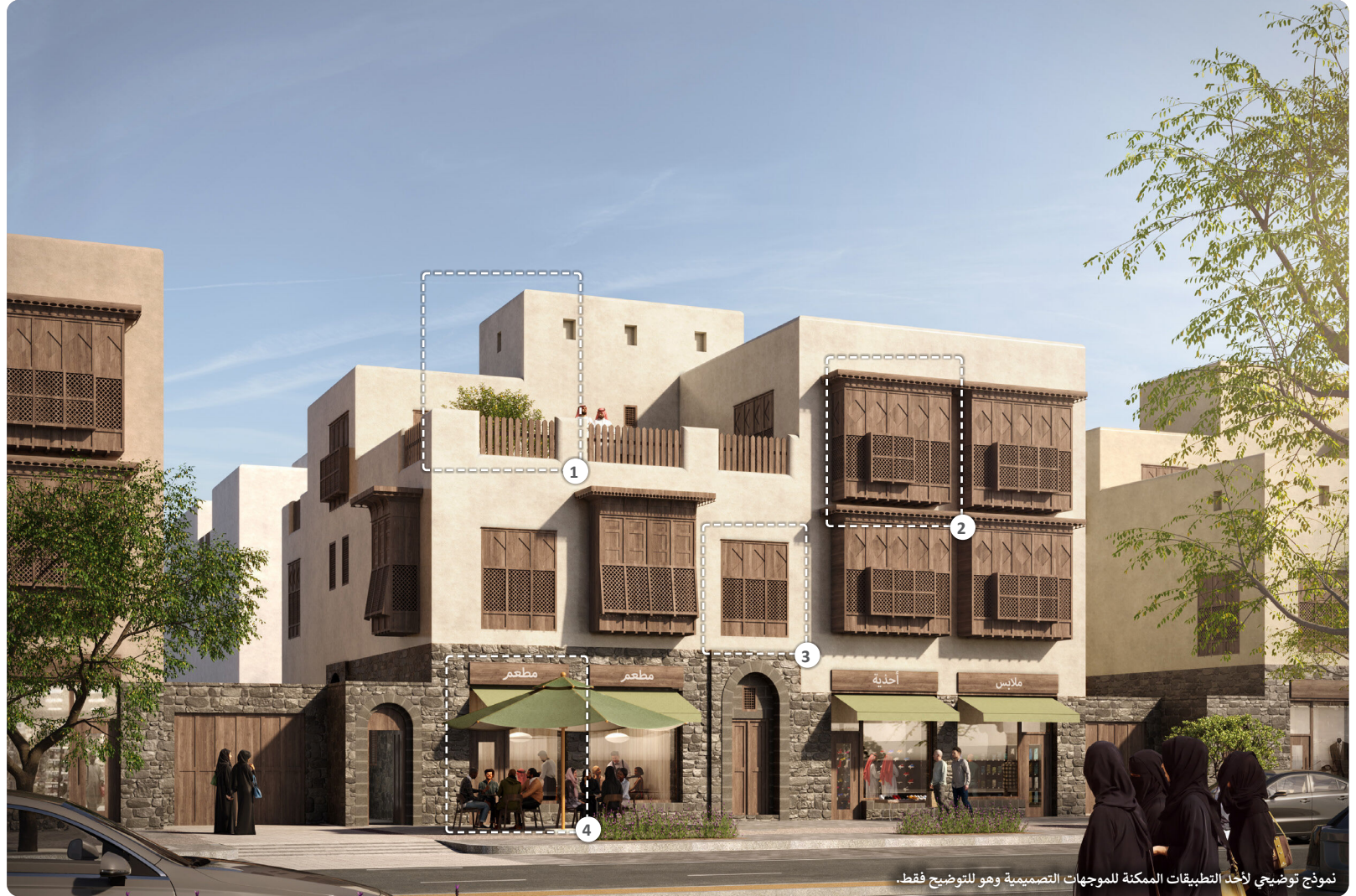
1 أسطح متدرجة مع درابزين مصنوع من الخشب. مساحة في السطح قابلة للسكن.
